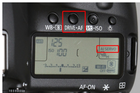
DRIVE・AFボタンを押し電子ダイヤルを回しAI SERVOにする
