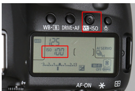
ISOと書かれたISO感度設定ボタンを押して、電子ダイヤルを回しISO100に設定する
