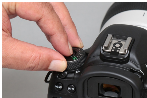
左上部のモードダイヤルは中央のロック解除ボタンを押しながら回す
