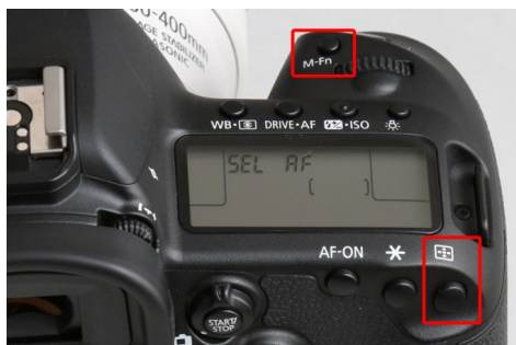
ファインダーを覗き背面右上のAFフレーム選択ボタンを押し、M-Fnボタンで測距エリアを選択する
