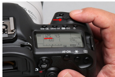
電子ダイヤルを回すとシャッター速度が上下する
