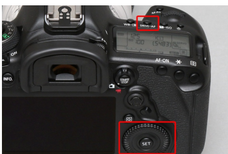
DRIVE・AFと書かれたボタンを押し、背面のサブ電子ダイヤルを回す
